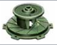
Non-clog Cutting Impeller ใบพัดตัดเส้นคาร์ไบด์ ติดตั้งเข้ากับ Suction Cover เพื่อให้เป็นกลไก ตัดเศษวัสดุที่ตกมากับน้ำที่สูบน้ำ
