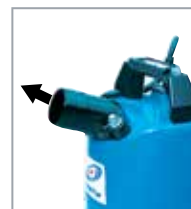
Oil Lifter กวนน้ำมันเพื่อหล่อลื่น ซีล 2 ชั้น ที่บนและล่าง เพื่อช่วยยืดอายุการใช้งานของ Mech Seal
