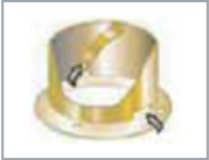
Oil Lifter กวนน้ำมันเพื่อหล่อลื่นซีล 2 ชั้น ทั้งบนและล่าง เพื่อยืดอายุการใช้งาน ของ Mech.Seal
